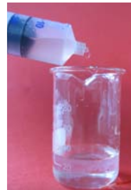
Figur 1. Lactase-natriumalginatopløsningen drypper ned i \text{CaCl}_2 -opløsningen.
